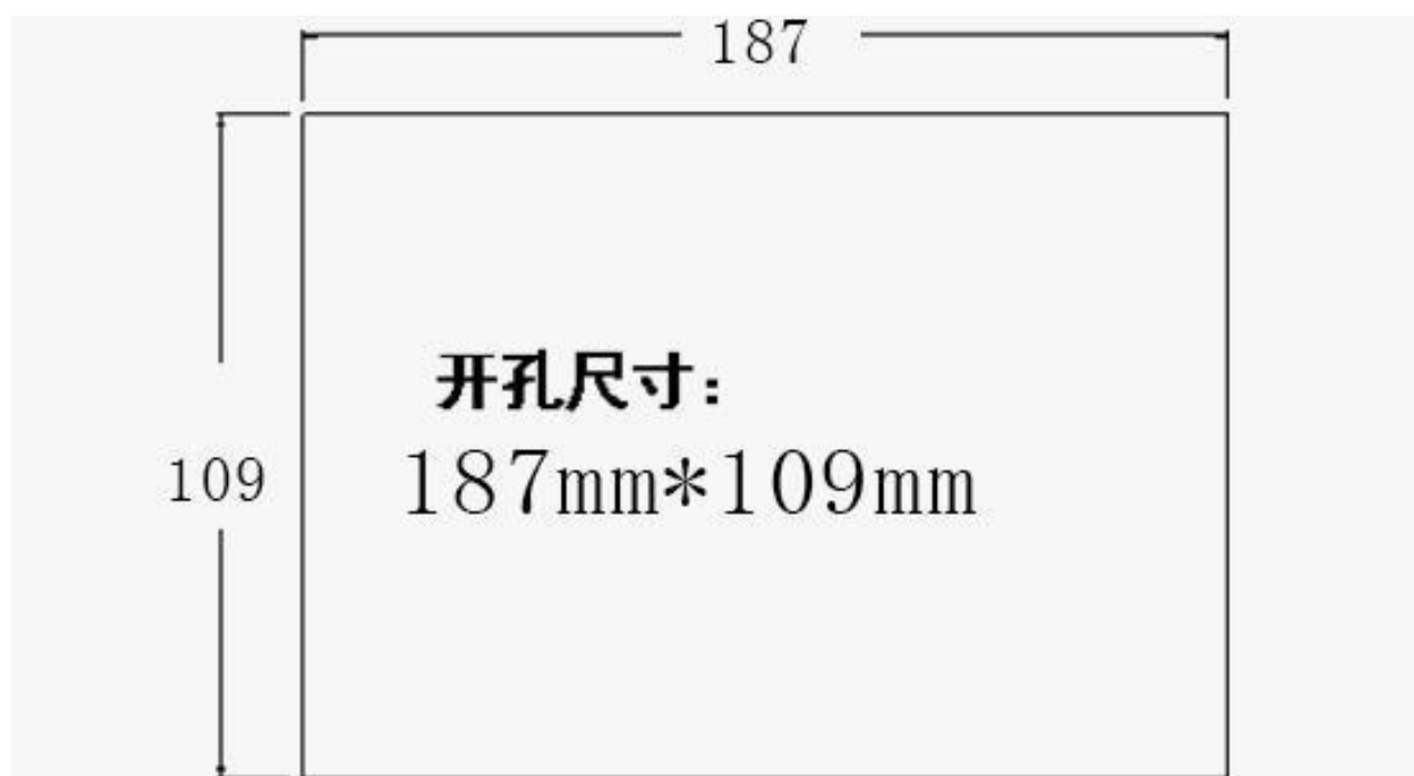
触摸屏开孔尺寸为：187mm x 109 mm
